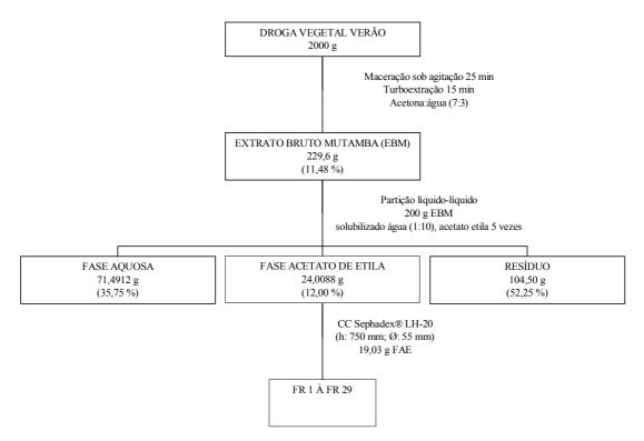
Fluxograma 2 – Preparação de extratos a partir das cascas de *Guazuma ulmifolia* e fracionamento da fração acetato de etila por cromatografia em coluna
