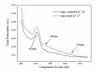
Figura 46 – Espectros de absorção para pele tratada e controle de 13 dias
