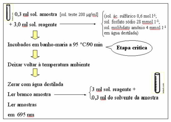
Figura 9 – Esquema da técnica do fosfomolibdênio para avaliação da capacidade antioxidante Fonte desenhos: NVTech, 2005.
