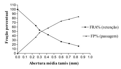
Figura 12 – Curvas de retenção e passagem da droga inverno após tamisação
