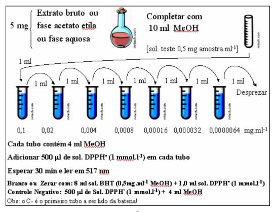
Figura 10 – Esquema do método de DPPH para avaliação da capacidade antioxidante Fonte desenhos: NVTech, 2005.
