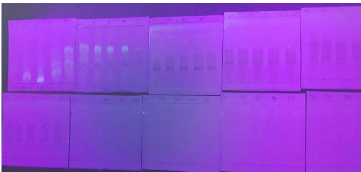
Figura 24- CCD do fracionamento de F2.3 de Trichilia catigua observado sob luz UV à 365nm.
