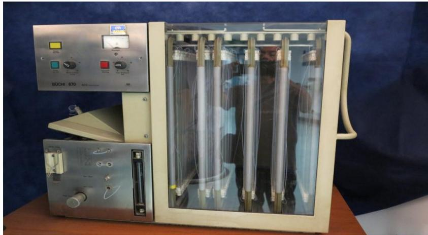
**Figura 6-** Cromatógrafo de contracorrente em gotas. Fonte: Istituto di Chimica Biomoleculare. Consiglio Nazionale delle Ricerche. (BÜCHI MOD. 670), 1987.
