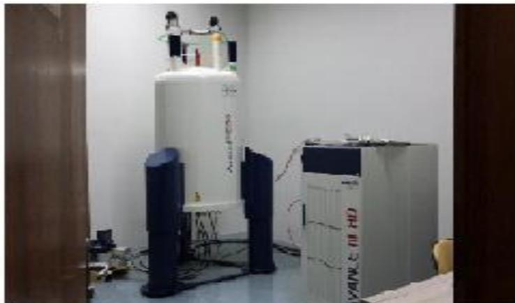
**Figura 11** - Espectrômetro de Ressonância Magnética Nuclear 500 MHz, Bruker, modelo AVANCE III HD. Fonte: Laboratório de RMN, Bloco 31, salas 11 e 12, UEM.
